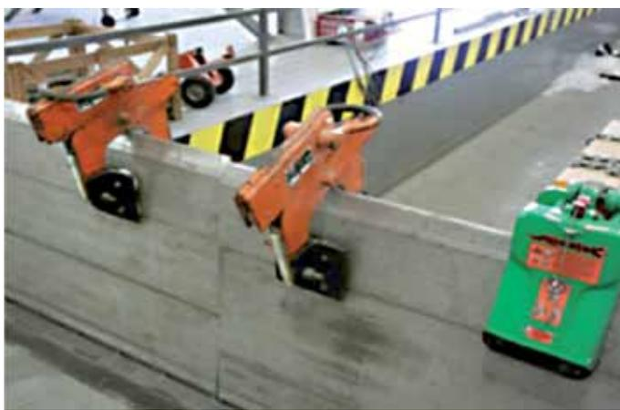
Для открытия упаковки или транспортировки отдельных плит, должен использоваться зажим типа "крокодил" или стандартный зажим (и тот и другой прорезиненный), как показано на картинке.
